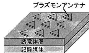
図 1 アンテナ積層構造の薄膜構成
